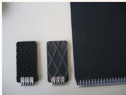
Superfici lisce, a impressione tela e a nido d'ape con giunzione meccanica
