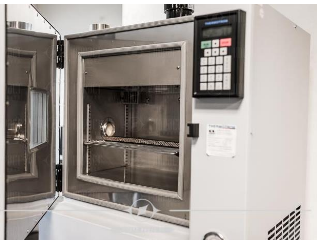
Les échantillons de caoutchouc sont congelés avec de l'azote liquide
